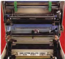
La gestione delle carte nelle fasi di stampa è affidata ad un blocco meccanico sovrastato al coperchio della periferica. È visibile il sensore che controlla il movimento della carta.
